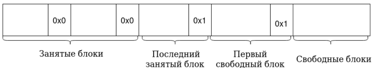
Рисунок 21 – Структура кучи NVRAM после записи 0x1 в k + 1 -ый байт первого свободного блока
