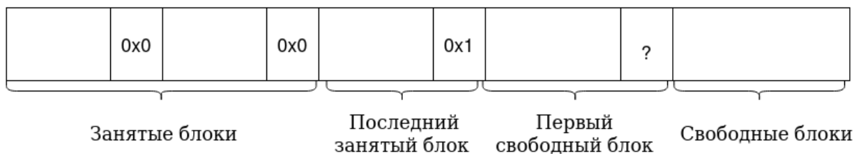
Рисунок 20 – Структура кучи NVRAM до начала перемещения границы аллокации вправо
